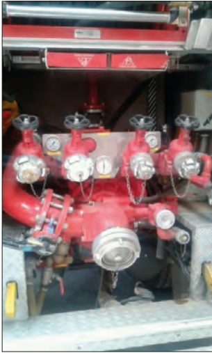
Imagen 41. Bomba con sistema de anillo de agua
