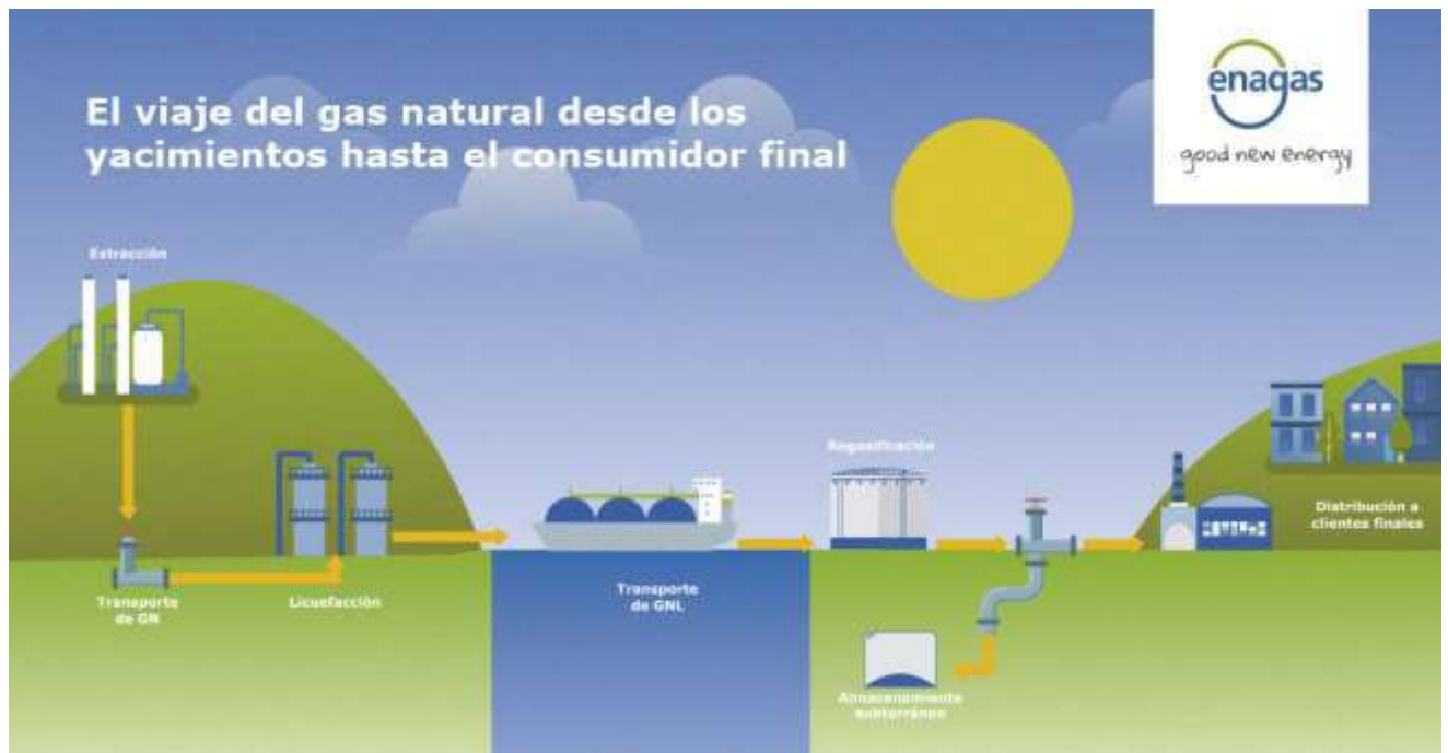
Fig. 16 Esquema de distribución del gas natural. ENAGAS.
