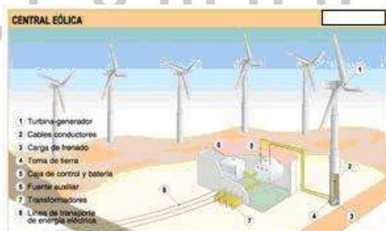
Fig. 20 Esquema de funcionamiento de una central eólica.
