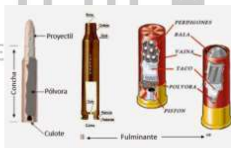
Fig. 18 Partes de cartuchos, metálico y semi metálico.
