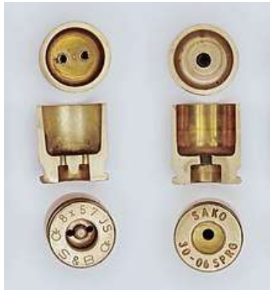
Fig. 21 Corte transversal de dos vainas: Berden (izq.) y Boxer. (der.)
