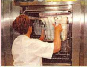
Carga de un autoclave con bolsas mixtas que han sido previamente colocadas en cestillos.
