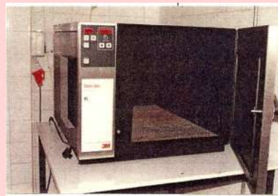
Estufa aireadora de material esterilizado con óxido de etileno
